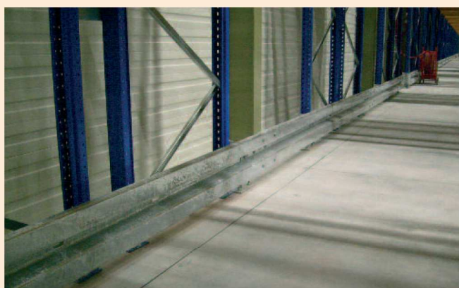
Vangrail B-profiel ter bescherming stellingpoten
